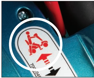
Freilaufhebel nach oben: - mit die Hand bedient - Bremse ist NICHT EINGESCHALTET!
